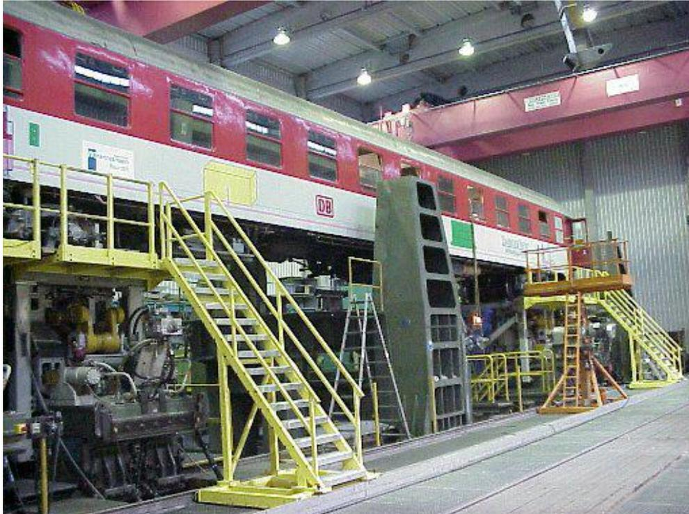
Abb. 20: Prototyp auf dem Rollenprüfstand der DB in München
