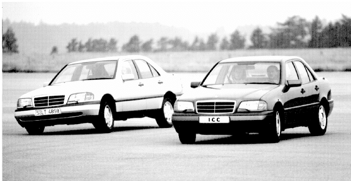
Bild 10.10: Vergleich des Kurvenverhaltens zwischen Serienfahrzeug (linkes Fahrzeug) und Testfahrzeug mit aktiver Feder (rechtes Fahrzeug)
