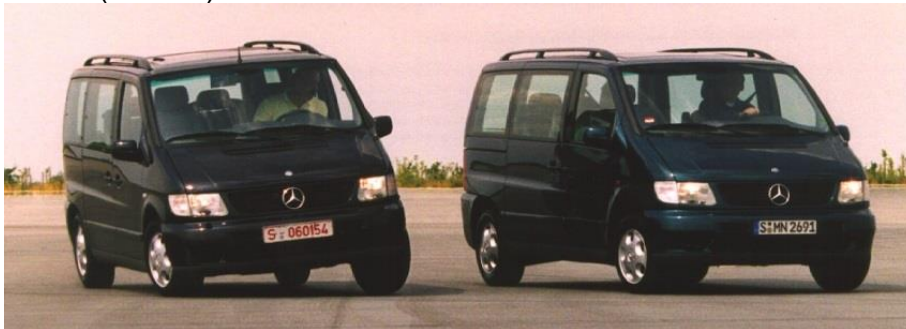
Bild 11: Modellgestützte Komfortregelung in der V-Klasse mit hydropneumatischen Federbeinen. Vergleich zwischen passiv (links) und aktiv (rechts) bei Kurvenfahrt
