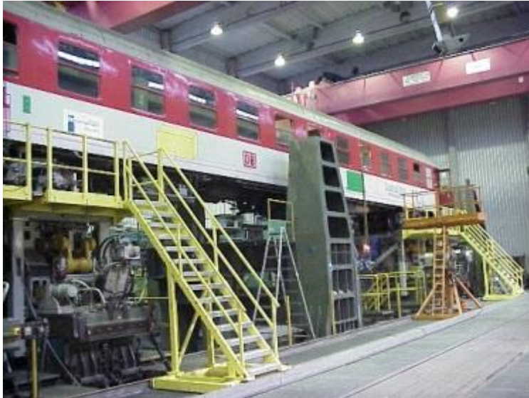
Bild 10: Modellgestützte Querkomfortregelung für Hochgeschwindigkeitszüge auf dem Prüfstand in München
