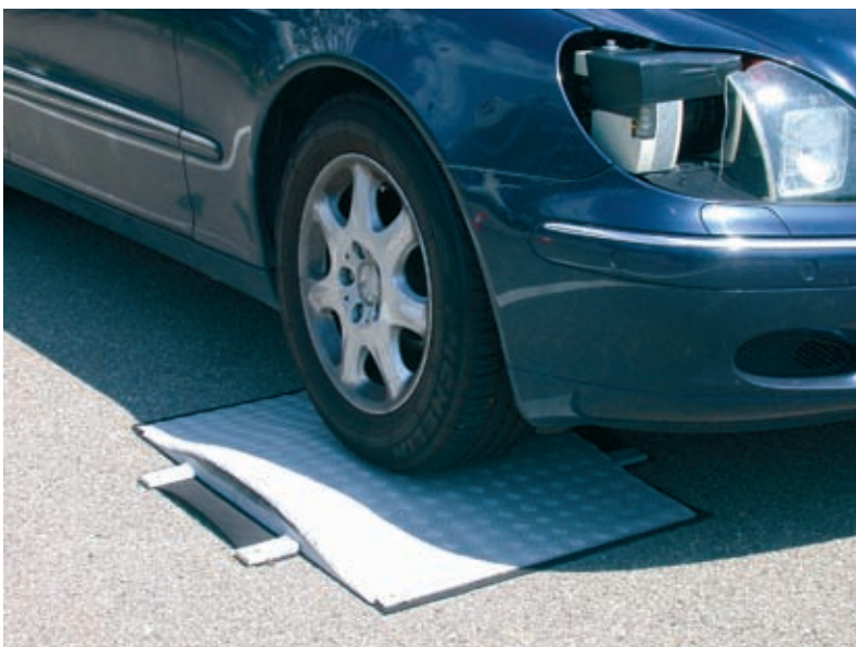
Bild 7: Überfahrt der Pre-Scan-Schwelle
